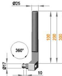
**Rollenhalterung Ø25 drehbar**
