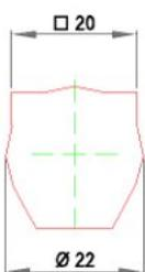
Die Werkzeugträger sind für Werkzeugaufnahmen mit 22mm Durchmesser sowie für 20mm quadratischen Querschnitt ausgelegt.
