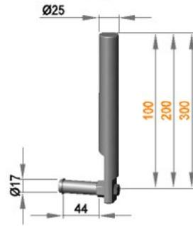
**Rollenhalterung Ø25 drehbar**
